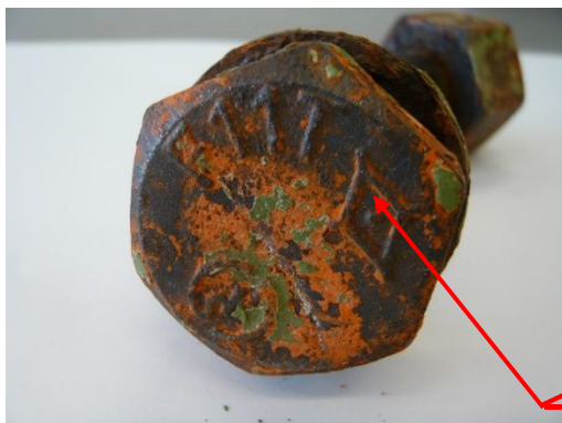
写真 2.4.3 F11T ボルトヘッドマーク
