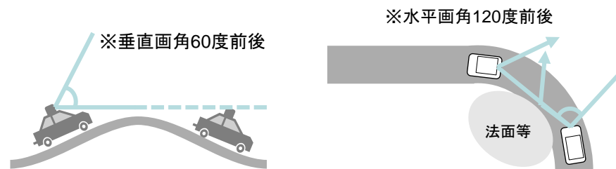
▲車両センサーの届かない箇所における道路状況把握の補助
