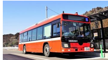
JR東日本+先進モビリティ (磁気マーカによる自車位置特定)
