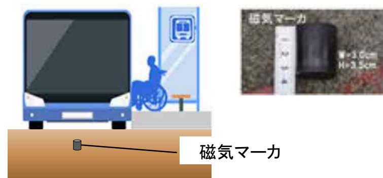
▲磁気マーカによる自車位置特定による運行の補助
